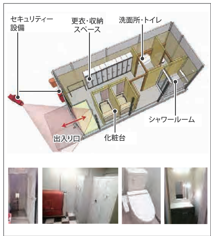
現場事務所への女性専用設備・スペース導入イメージ図及び導入実績写真
