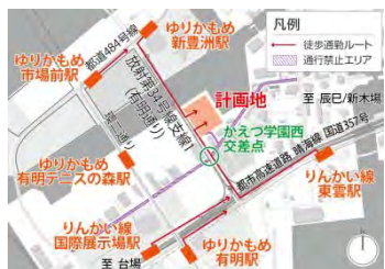
作業員の徒歩通勤ルート
