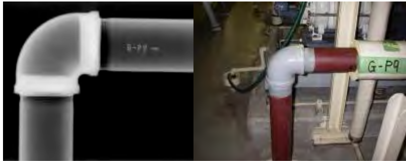
写真：放射線透過試験を用いた劣化診断
