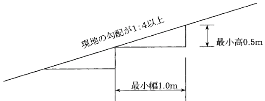
図3. 2-1 盛土基礎地盤の段切
