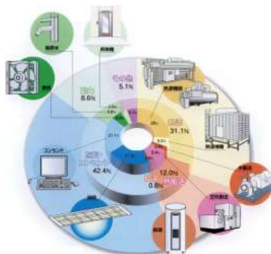
図15.2 空気搬送系のエネルギー消費割合(オフィスビルの事例) (出典:「オフィスビルの省エネルギー」(一財)省エネルギーセンター)
