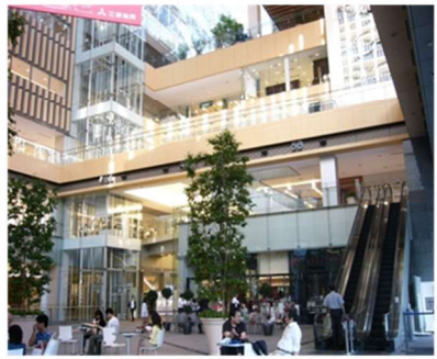
建物入口から入ると、シースルーEVとエスカレーターが一瞬にして見渡せる例 ※丸ビル
