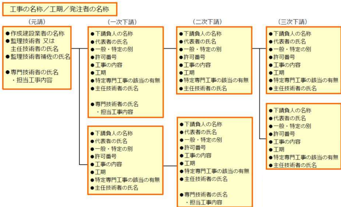
図5-2：施工体系図記載事項について（三次下請までである場合の例）
