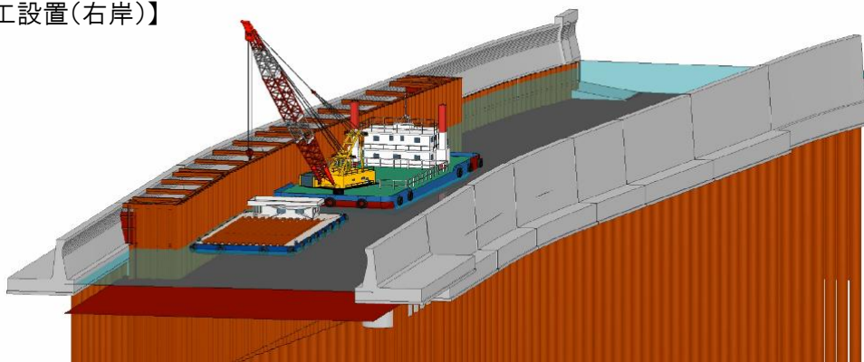
施工手順説明用3Dモデル
