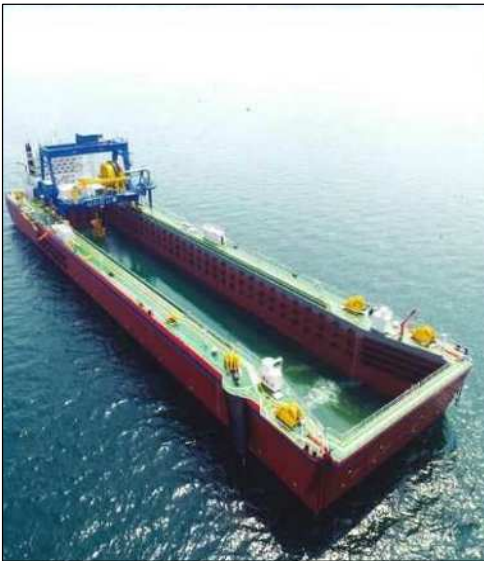
汚濁防止枠付土砂送泥船【第2てんゆう】 Anti-Pollution Soil Transporter
