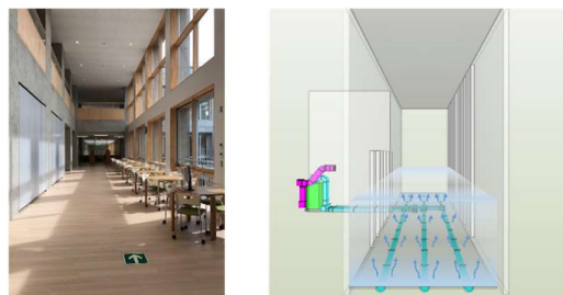
図 4-1：対話コーナー（吹抜け）における床ふく射空調の採用
