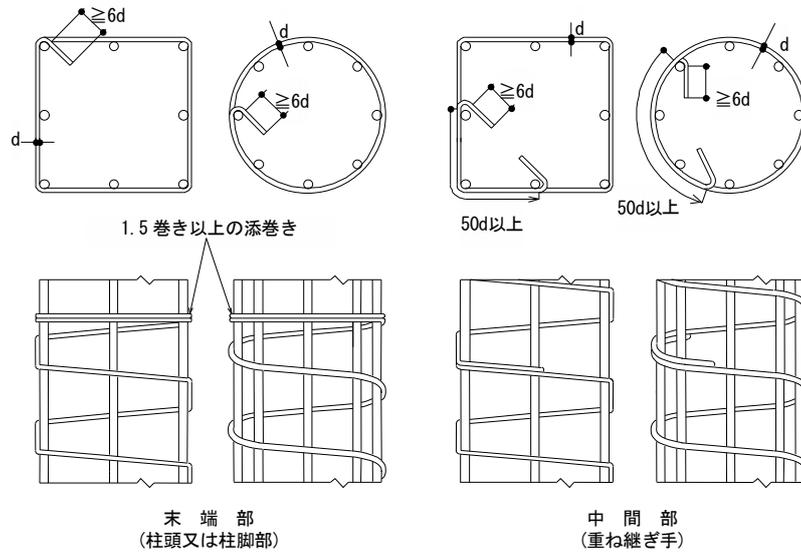
図 5.3.5 スパイラル筋の継手及び定着
