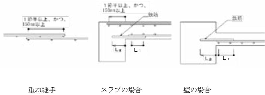
図 5.3.4 溶接金網の継手及び定着
